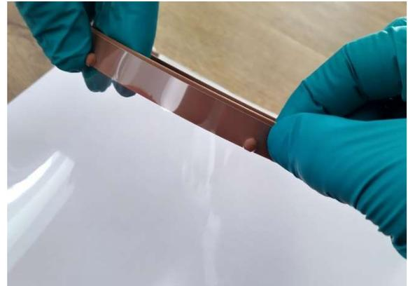
2. Die Folie Seite für Seite, mit leichtem Zug in die beiden äußeren Pins einklipsen und den Folienüberstand hinter die Lasche stecken
