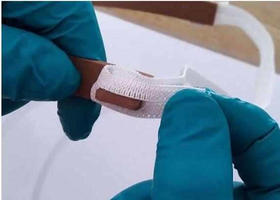
2. Die Folie in die beiden mittigen Pins am Bügel einhängen
